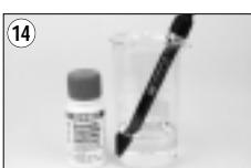
diode über dem Taster zu blinken beginnt. Das Gerät eicht jetzt automatisch pH 7, die Anzeige zeigt "E 7" ⑧.
