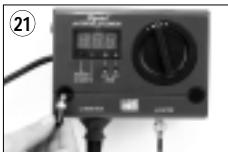
Zekering vervangen: de pH-controller van het elektriciteitsnet halen. De zekeringhouder (links) eruit schroeven en de defecte zekering verwijderen **(21)**. Er een nieuwe zekering van hetzelfde type (elektro-specialzaak) inzetten en de zekeringhouder er weer inschroeven.
