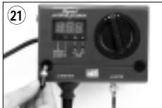
Sostituire il fusibile: staccare la corrente del regolatore di pH. Svitare il portafusibili (a sinistra) e rimuovere il fusibile guasto **(21)**. Introdurre un fusibile nuovo dello stesso tipo (rivolgersi ad un negozio specializzato) e riavvitare il portafusibili.
