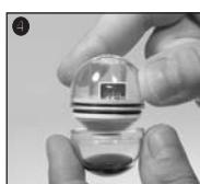
5. Testbehälter vorsichtig umdrehen und in Haltespange einsetzen.
