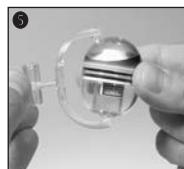
6. CO<sub>2</sub> lange termijn-test met behulp van de zuiger op een goed zichtbare plaats met geringe stroming van het water verticaal in het aquarium bevestigen. Kleurenvergelijgings-schaal aan de buitenkant op de aquariumruit plakken.
