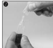
3. Verser tout le contenu de l'ampoule dans la partie supérieure de la capsule-test.
