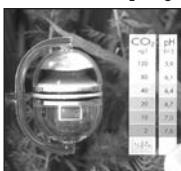
Mät karbonathårdheten och använd alltid motsvarande färgskala.
