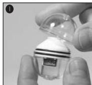
2. Eine Ampulle mit CO<sub>2</sub> Special-Indicator nehmen und sicherstellen, dass sich kein Indikator im Ampullenhals befindet! Dazu Indikator in der Ampulle herunterschütteln (wie bei einem Fieberthermometer). Ampulle durch Abdrehen der Verschlusslasche öffnen.
