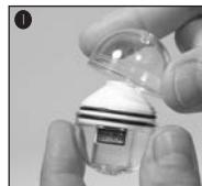
2. Een ampul met CO<sub>2</sub> special-indicator nemen en ervoor zorgen dat er zich geen indicator in de ampulhals bevindt! Daartoe de indicator in de ampul naar beneden schudden (als bij een koortsthermometer). De ampul openen door de afsluitklem te openen.
